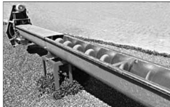
Figura 6: Transportador helicoidal
